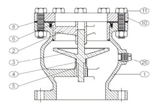
FIGURE 4. FLANGED VACUUM BREAKER
